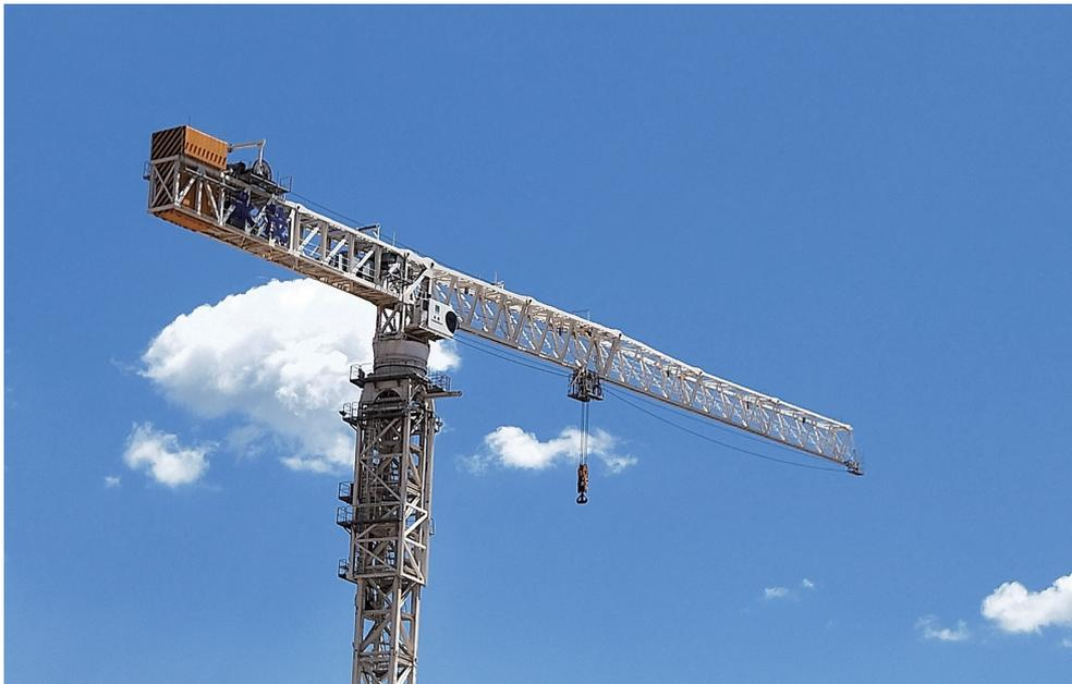
塔頭式塔式起重機的設計側重於安全性及可靠性。塔頭式塔式起重機的臂架截面較小，故受力能力更佳，抗過載能力出色。相較其他型號的塔式起重機而言，臂架截面較小的塔頭式塔式起重機承載的力度因其採用的拉桿結構而減小，此意味著塔頭式塔式起重機的使用壽命通常較長。塔頭式塔式起重機的運輸成本因其拉桿結構而相對減少。塔頭式塔式起重機因其應用範圍廣而為塔式起重機服務行業使用最廣泛的塔式起重機。於最後可行日期，我們擁有281台塔頭式塔式起重機，及我們最大的塔頭式塔式起重機的最大起重能力為1,200噸米。
