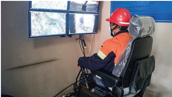
挖机驾驶员通过5G技术远程操控的挖掘机正在矿区采场边坡有序的作业
