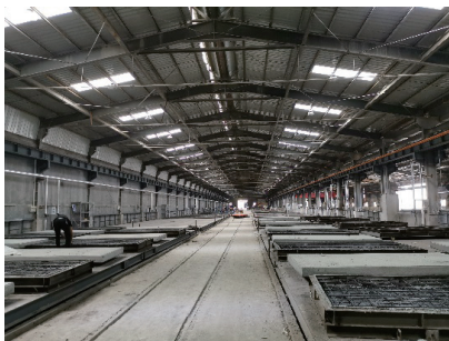
預製混凝土構件固定式生產線
