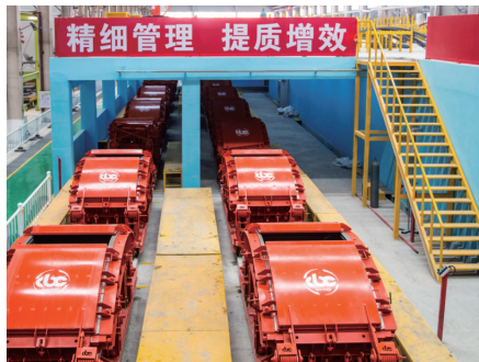
預製混凝土構件環形生產線(盾構管片) (附註)
