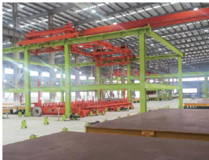
預製混凝土構件環形生產線(其他建築構件)
