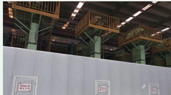
厚板線打砂機隔音牆
