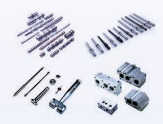
精密機加工件為本集團第二大業務分部,佔本集團截至二零二零年十二月三十一日止年度的收入31.7%。精密機加工是指利用電腦數控及其他設備及工具,對各種成品所用的金屬零部件進行高精度規格的鑽孔或成型加工。精密機加工在採購自全球第三方供應商的棒材及其他成型材料上進行。
