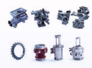
熔模鑄件為本集團最大業務分部,佔本集團截至二零二零年十二月三十一日止年度的收入44.7%。熔模鑄件是一種金屬成型工藝,是在蠟模表面,採用陶瓷耐熱材料塗覆的方法形成的陶瓷模。形成的陶瓷模經過乾燥、蠟模熔化去除形成陶模模殼。然後將熔融金屬倒入陶瓷模殼中以形成鑄件。隨後將模殼去除,獲得鑄件。一些熔模鑄件需要在鑄造後進行二次機加工。熔模鑄件通常用於生產形狀複雜且需要高精密度及表面粗糙度要求高的零部件。
