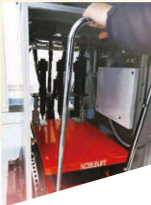
高壓電力開關設備測試裝置，為處理重型設備的員工提供保護，避免發生工傷意外。
