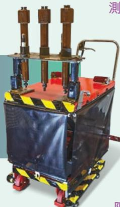
測試高壓電力設備的絕緣性能，是校驗或維修工作完成後的必要程序。操作人員會以人手將重達9公斤的測試插頭，插入帶電的高壓電力開關櫃內的狹窄斷路器室。此工序涉及多項安全風險，包括人力提舉重物和接近可能產生跳火的帶電高壓插座。
