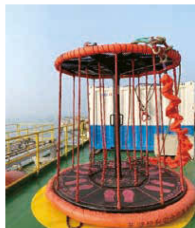
钻井事业部海上各一线生产单位全面配备硬质吊笼,在人员转运过程中,硬质吊笼支撑杆可以有效避免船体由于涌浪起伏导致的吊笼、人员摆动,提高平台应用船舶倒班上下平台时,吊人作业的安全性。
