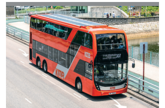
九巴在雙層巴士安裝太陽能板後，有助降低車廂溫度
