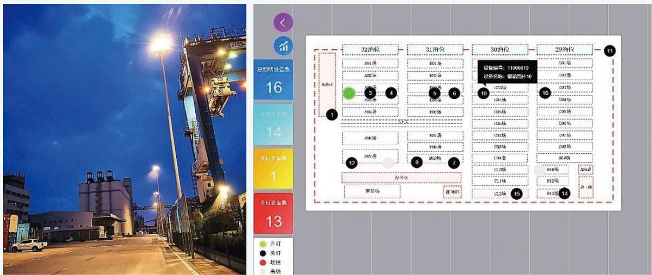
採用智能照明系統後，碼頭在操作、照明、節能等方面均呈現優勢。員工可直接使用中央電腦、手機等智能裝置實時監控並操作照明系統，亦可根據天氣和作業情況批量開關多組智能燈。每個燈塔故障及能耗信息能實時顯示，方便進行能源分析和故障處理。
