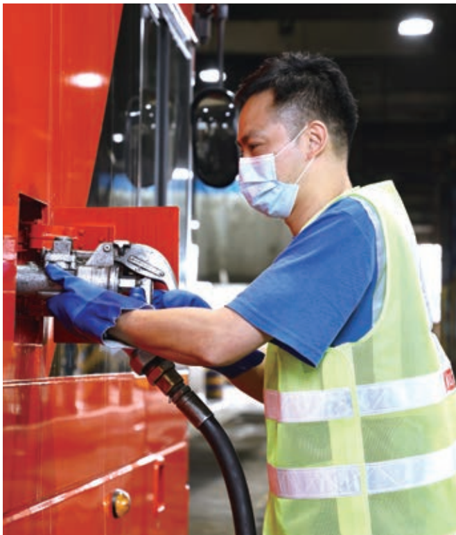
九巴及龍運採用飛機使用的加油系統，防止燃油外溢
