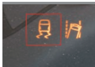
電子穩定系統有助減低巴士轉彎時翻車的風險
