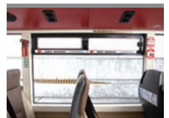
九巴在部份巴士加設通風口，增加車廂內空氣流通
