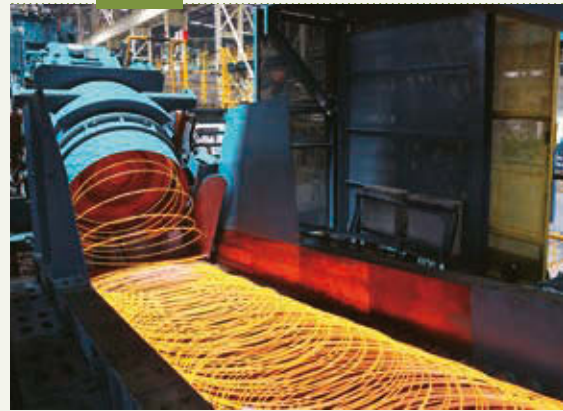
■ 中信泰富特鋼2000兆帕級纜索鋼絲用盤條生產車間
