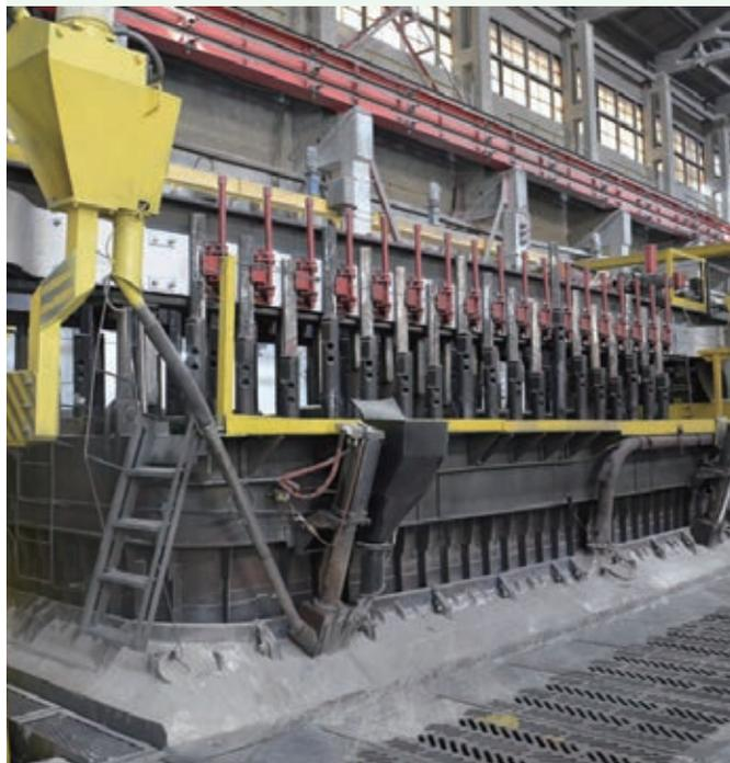
以下是減少多環芳烴碳排放的新研發項目列表：陽極平面降溫－散熱片及更高的陽極體；陽極糊中含有碳添加劑，可以形成密封層，阻止陽極平面的排放。
