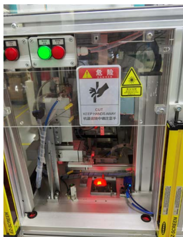
在中國無錫安裝 激光打標設備， 以溶劑代替 墨水打標
