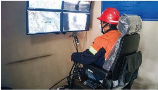
挖機駕駛員通過5G技術遠程操控的挖掘機正在礦區採場邊坡有序的作業
