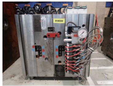
安裝熱流道 模具以減少 廢料，每年 節省25噸 塑料原料
