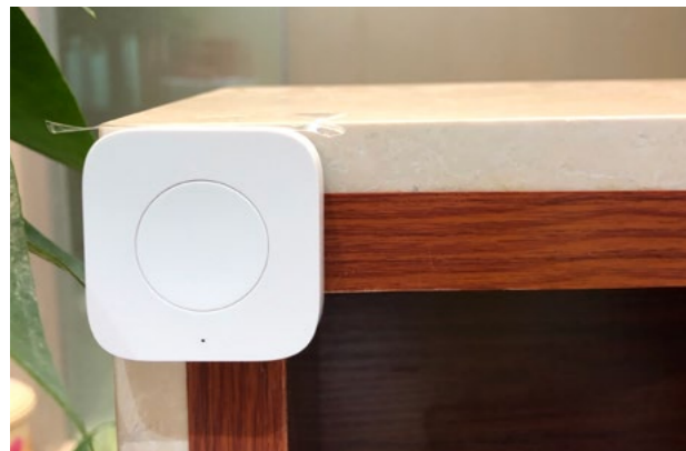
金茂珠海響應節能減排號召，在辦公區域安裝智能開關、人體感應器等設備，實現燈具定時開閉及遠程控制，並設置 30 分鐘區域內無人移動自動關閉燈具和壁掛式空調，減少資源浪費
