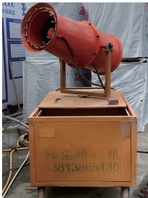
設置於工地各處的降塵裝置
