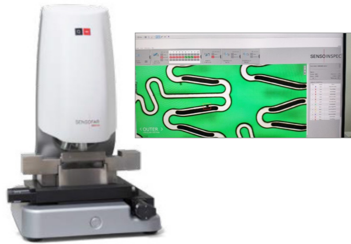
Q-six設備圖示和裸支架缺陷案例
