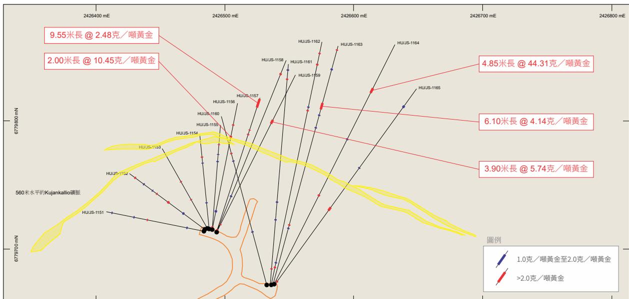
圖2—於Jokisivu金礦從560米及570米水平開始對Kujankallio主區及Kujankallio轉折端進行的地下金剛石取芯鑽孔活動(活動3)的平面圖。
