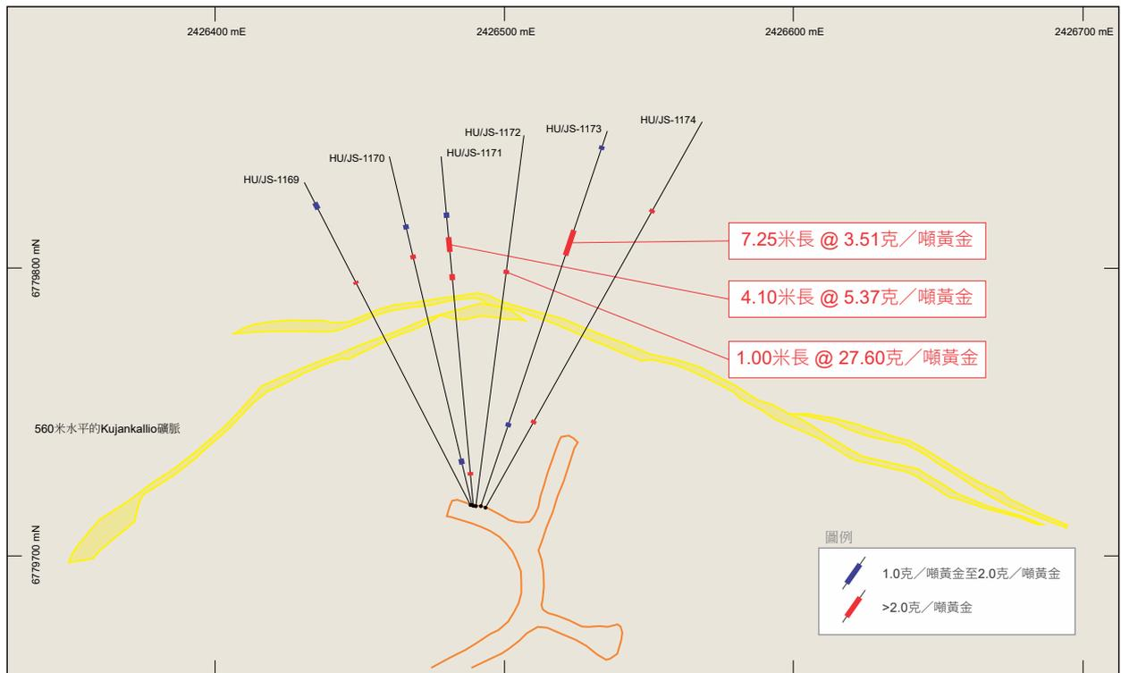
圖3—於Jokisivu金礦從570米水平開始對Kujankallio轉折端進行的地下金剛石取芯鑽孔活動(活動4)的平面圖。
