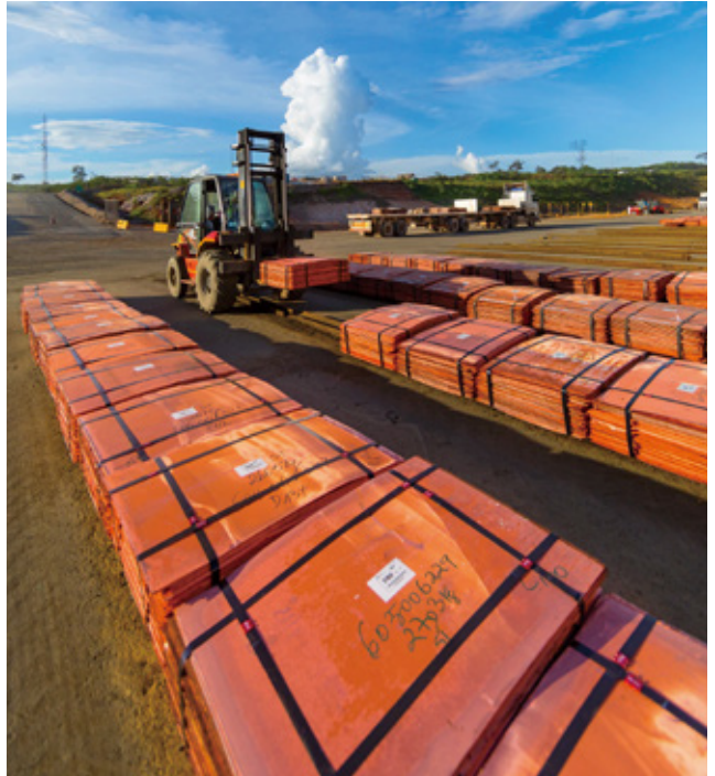
在刚果（金）TFM，所有的铜钴产品都使用条形码，以实现从矿山到冶炼厂的可追溯性。
