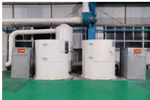
中国矿区钨业选矿二公司通过喷淋装置对配药过程中产生粉尘的回收，职工劳动强度显著降低，粗选药剂制备间整体环境得到显著改善，防止了职业病的发生。
