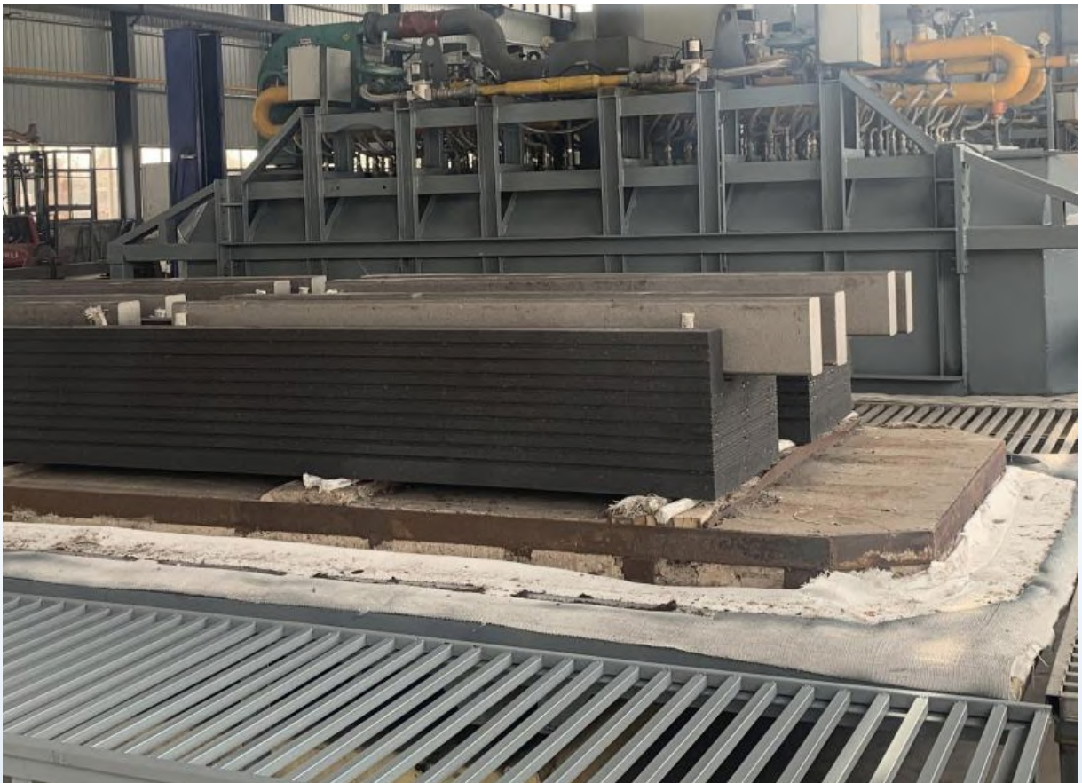
節能長壽命鋁電解槽陰極制造技術實施現場—燃氣預熱前
