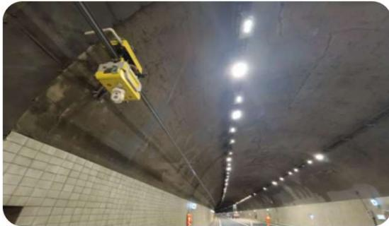
全國首台高速施工管理巡檢機器人在G50高速養護施工現場投入使用
