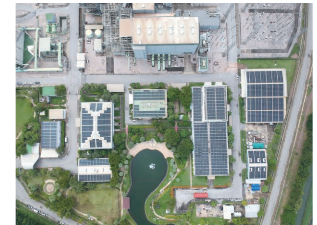
Ratchaburi 發電廠的屋頂太陽能系統為廠內的輔助發電系統供電。
