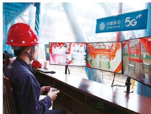
○ 工人在廣西公司打造的智慧綠色工廠中通過手柄遠程操控裝載機
