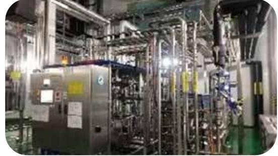
通過自主設計及實施, 將廠內冷凝水集中收集, 對熱水系統升溫及殺菌機預熱, 節省蒸汽用量。該技術2021年11月在廣州工廠完成改造, 2022年規劃在成都、長沙工廠實施, 預估年節省蒸汽用量**2,800**噸; 年減少二氧化碳排放量**830**噸。
