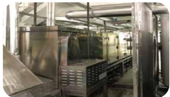
回收蒸箱二次蒸汽，運用蒸汽純化增壓技術，即熱能轉換及蒸汽壓縮後將回收的蒸汽供給蒸箱使用，節省蒸汽用量。該技術2021年已在武漢工廠導入應用，節省蒸汽用量共約**1,362**噸；減少二氧化碳排放量**404**噸。
