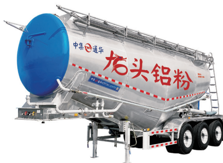
智能化鋁合金臥式粉罐半掛車
