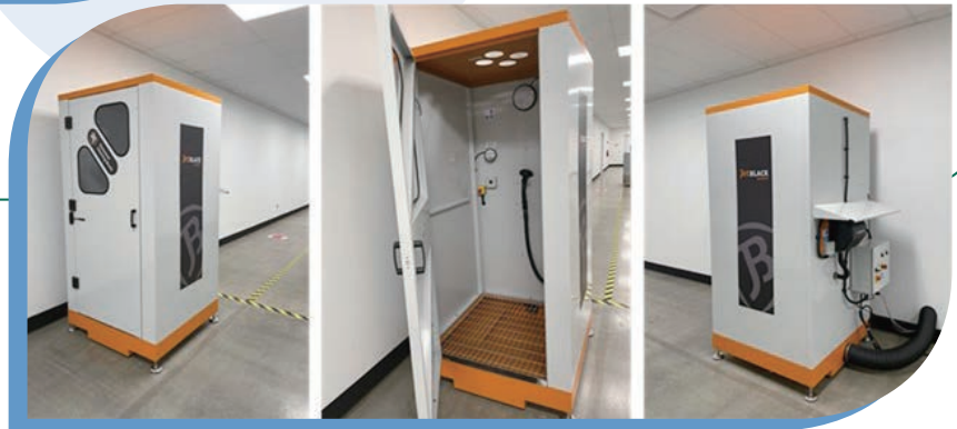
Vitaquest在100 Jefferson生產設施安裝的除塵安全亭。
