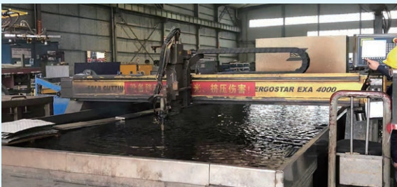
改造前－水下等離子切割機
