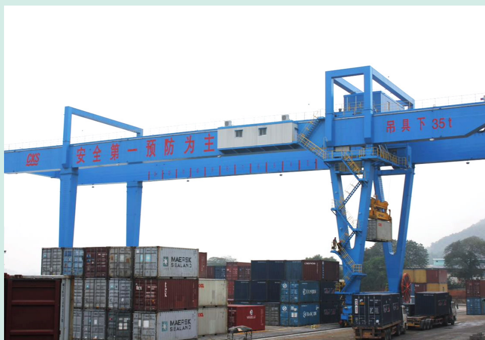
本集團採用電動龍門起重機及具變頻驅動器的橋式起重機，以減低能源消耗，從而減少相關的空氣及溫室氣體排放。
