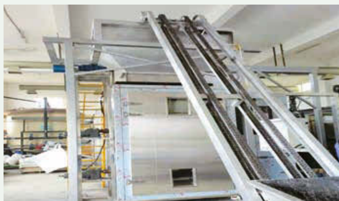
污泥乾化設備
