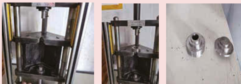
渦流紡皮輥脫裝工具改造前(左圖)及改造後(中及右圖)
