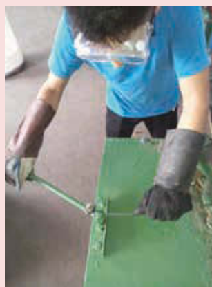
使用改造的鋼絲折彎機
