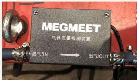
焊機安裝配套氣體流量監測裝置
