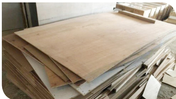
於建築地盤回收木材再用
