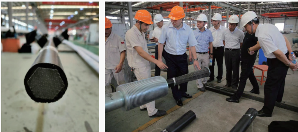
碳纤维拉索制造过程
