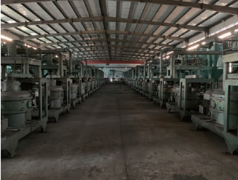
圖8-9：球形石墨加工廠的磨圓回路
