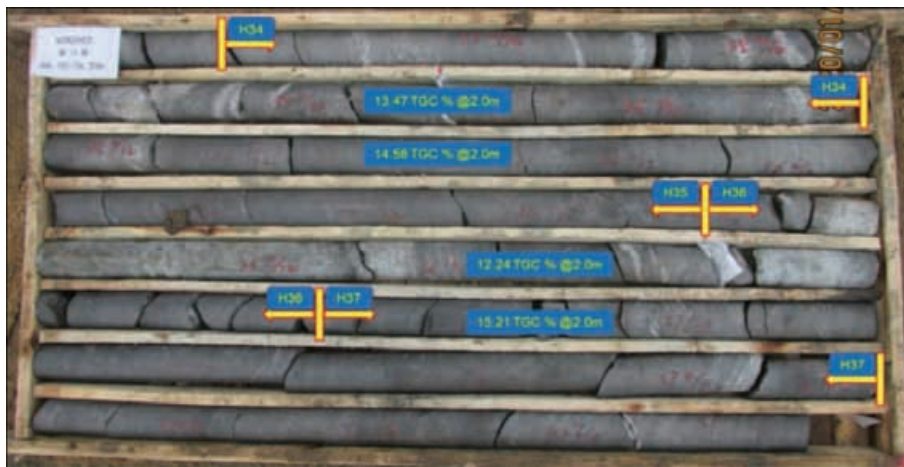
圖4-4： VZK0402鑽孔交切的石墨片岩
