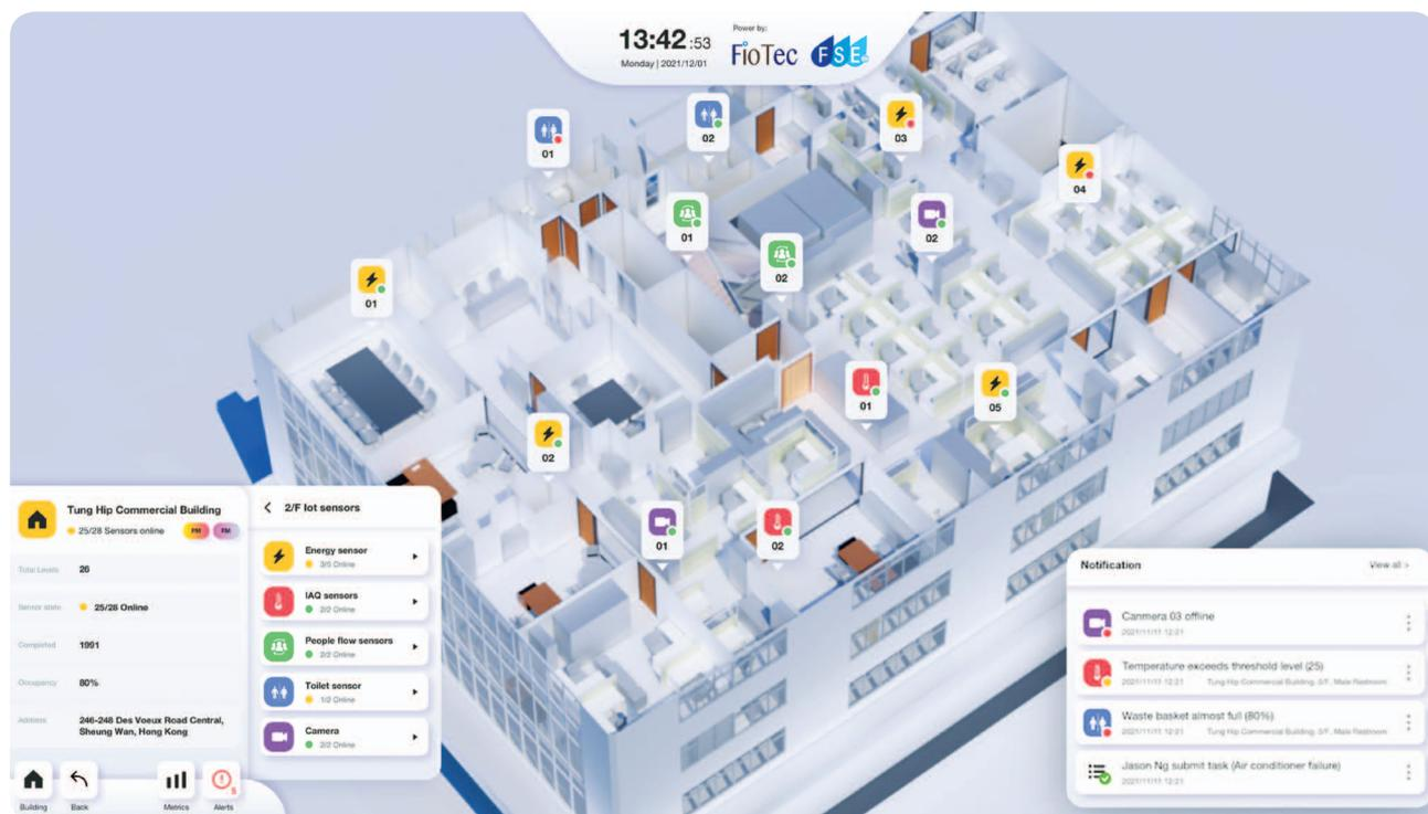
以FioTec開發的定制化和3D BIM功能儀錶板，顯示所有物聯網感測器的即時狀態
