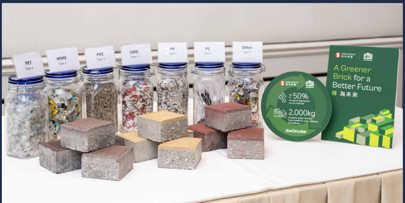
這項解決方案升級再造全部七類塑膠廢料成可持續建築材料，包括現時無法回收再造的混合塑膠和合成塑膠。
