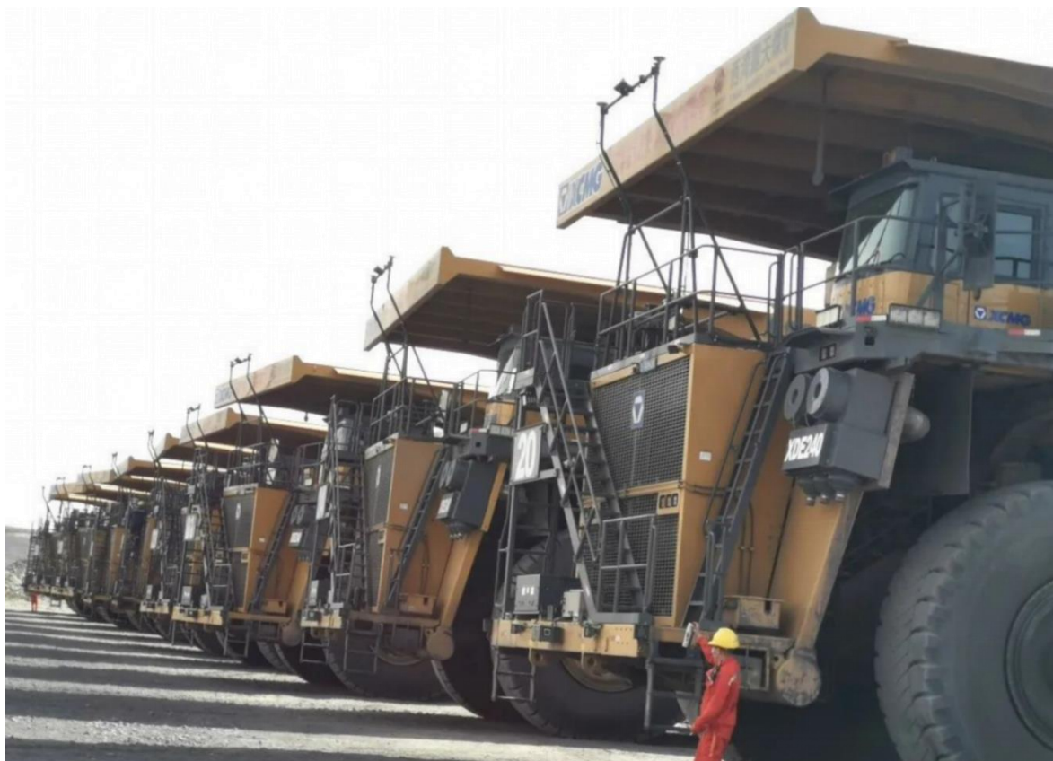
西灣露天礦卡項目實現礦用卡車“裝-運-卸”全流程無人駕駛和輔助車輛的協同作業
