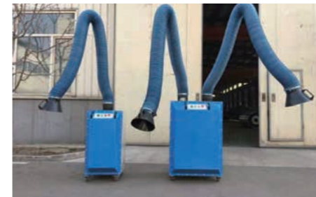
预制场配置移动式焊烟收集器等废气收集处理设备
