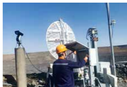
內蒙古太平邊坡穩定性雷達監測系統
