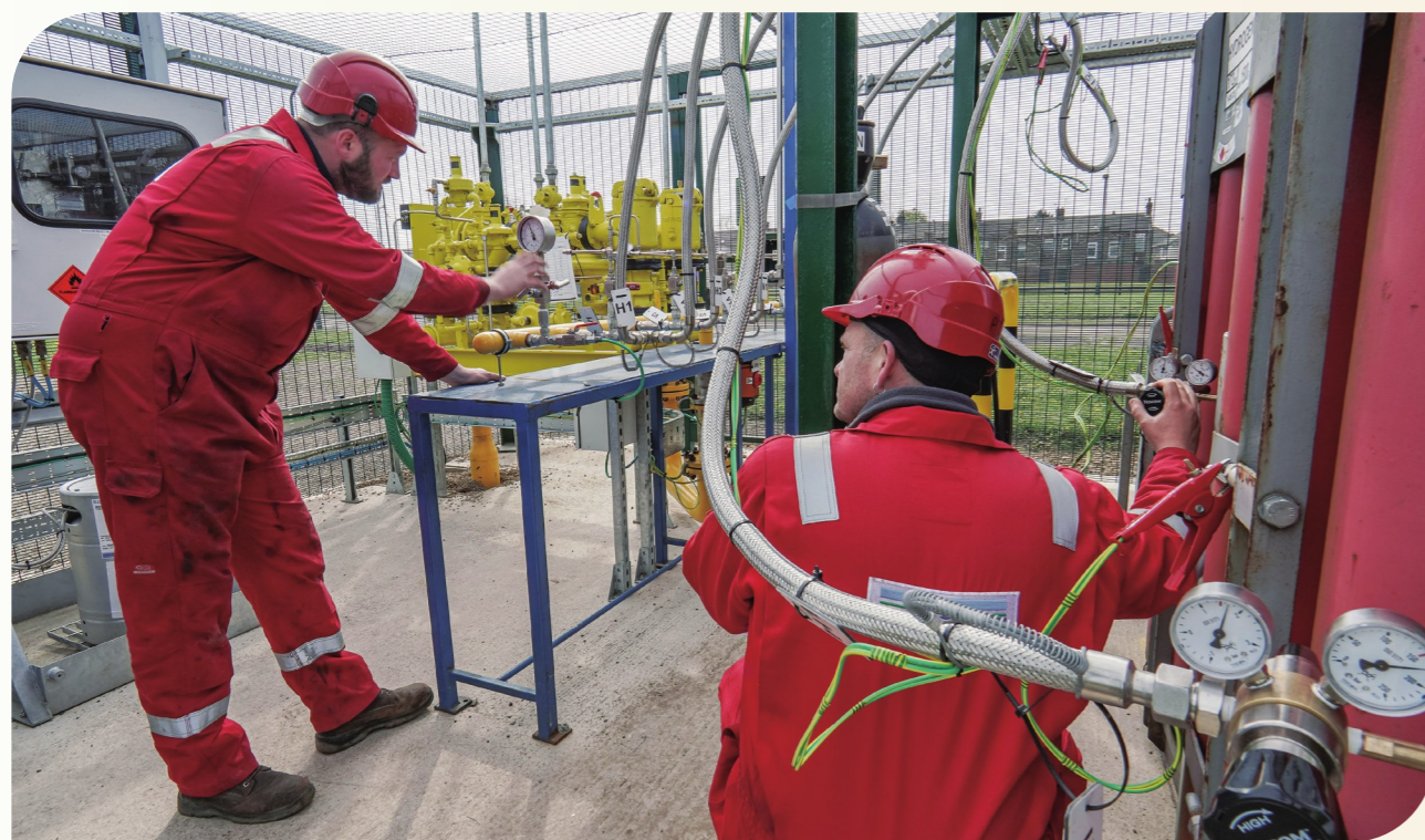
工程師在Middlesbrough的H21 South Bank站點測試在氫環境中的氣體運作程序。
