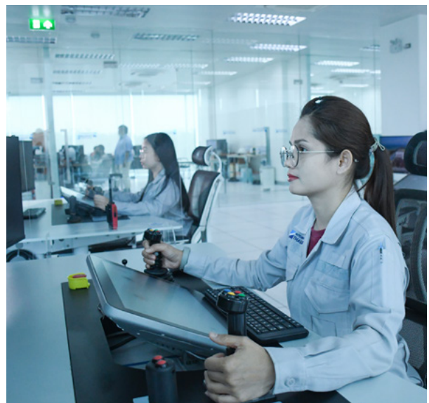
在和記港口泰國門的遙控碼頭起重機的中心。
