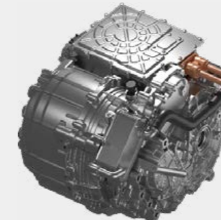
國內首款 200kW 油冷電驅 搭載於 C01/C11
