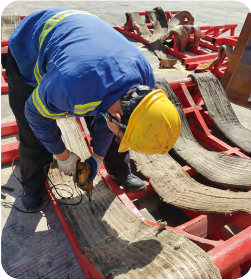
晉江太平洋碼頭的員工在鋼捲的鞍座安裝報廢吊裝帶，合理地將廢物循環再用。
