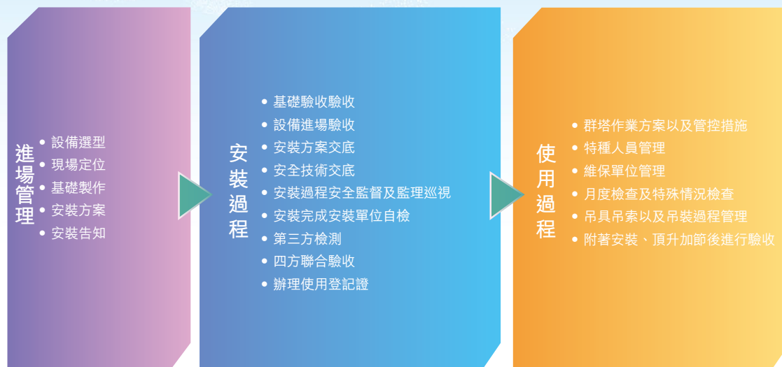
設備運行過程安全問題風險源管理
