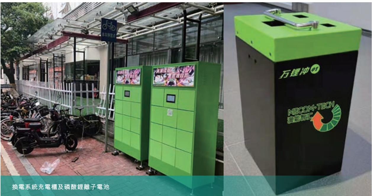
換電系統充電櫃及磷酸鋰離子電池
