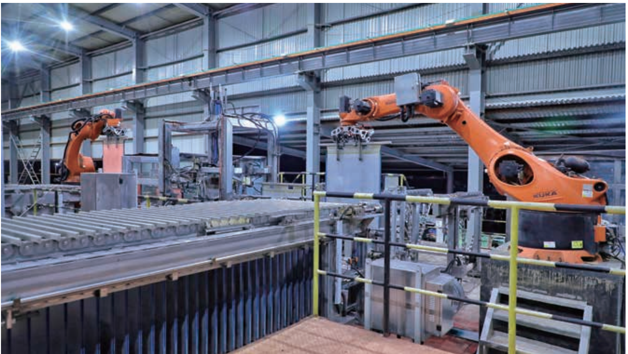
剛波夫礦業濕法廠電積車間陰極銅剝片作業
