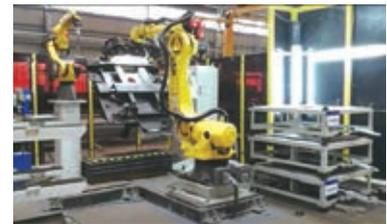
掛車的自動拼裝焊接技術是一種利用視覺識別技術對待加工零件進行識別及定位、利用智能搬運設備對待加工零件進行搬運和拼裝，並利用自動焊接設備對待加工零件進行焊接的技術。
