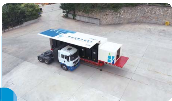
啟源芯動力 - 重型卡車電池充換站
